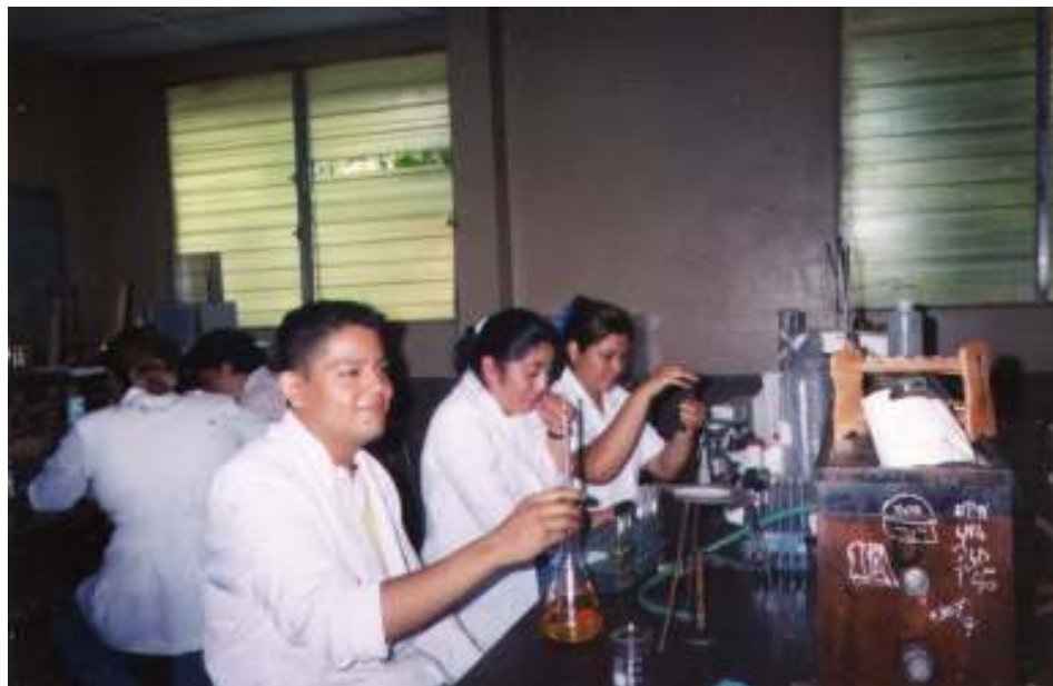
Investigadores realizando el procedimiento de la prueba presuntiva, inoculando 10 mL. de agua de pozo en caldo
